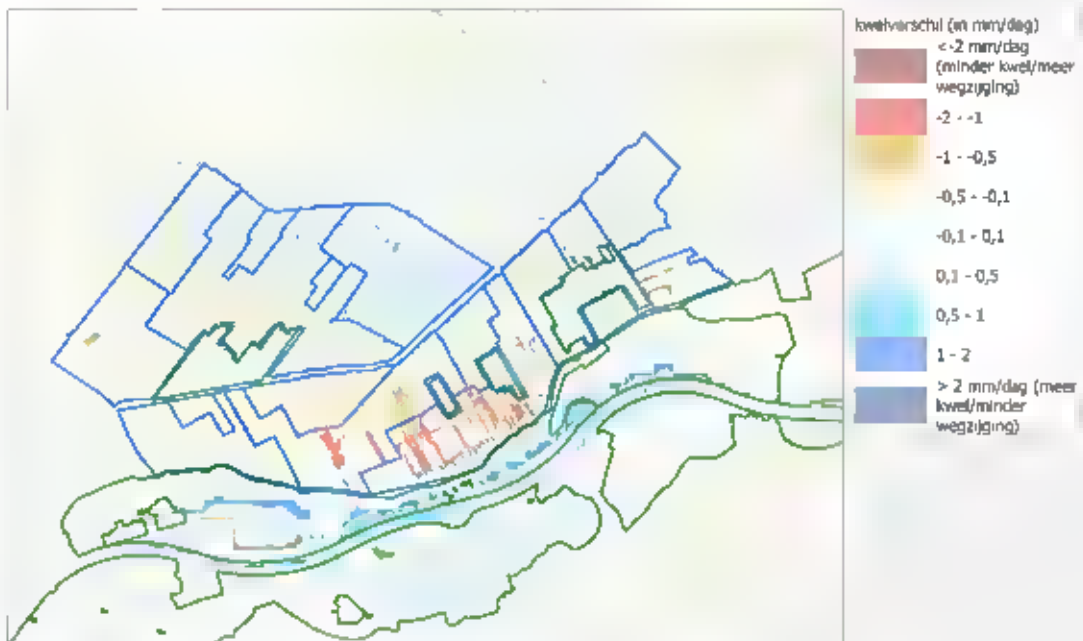
Figuur 4-30 Bouwsteen 3 : Effect op de kwel- en infiltratieflex (mm/d) voor de zomer t.o.v. de referentiesituatie.
